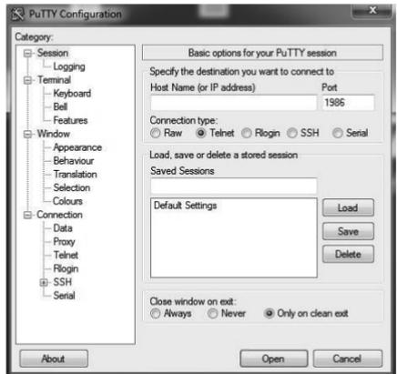
Utilisez les commandes de la **table de commande RS232/LAN**. Par exemple, si vous entrez la commande « GETVOLUME », le niveau de volume s'affiche sur la fenêtre mastic comme l'illustre les images ci-après.
